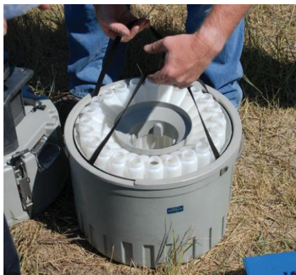
Il campionatore portatile compatto 6712C è dotato di un'esclusivo portabottiglie, che agevola la sostituzione e il trasporto delle bottiglie.
